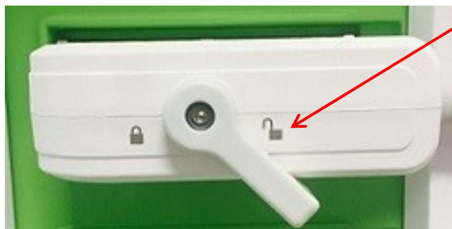
Figura 9: Manopola di bloccaggio sul connettore del trasduttore sbloccata
